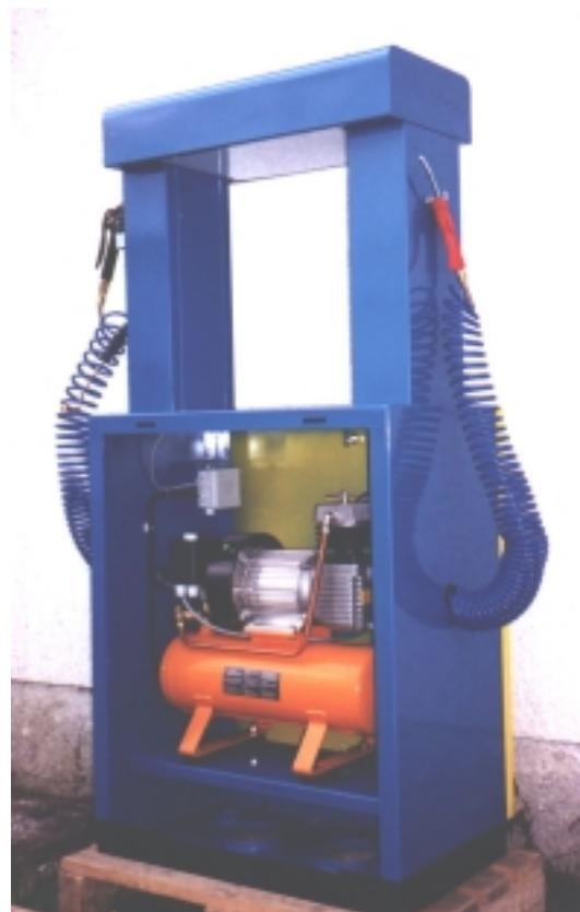
Slika 3: Fotografija stražnje strane tlakomjera za gume tip BASIS Z<sub>x</sub>-PS<sub>x</sub>
