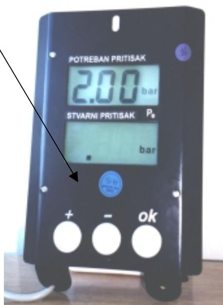
Slika 1: Fotografija tlakomjera za gume tip BASIS Z<sub>x</sub>-PS<sub>x</sub> s prikazom mesta za smještaj ovjerne naljepnice
